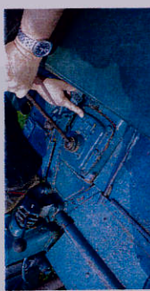
Im Hanomag arbeitet eine sogenannte Doppel-H-Schaltung mit sechs Gängen.
