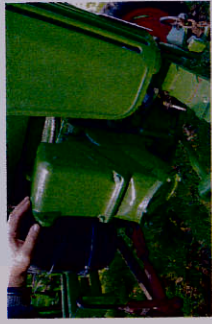
In dem auffälligen Gehäuse an der rechten Seite läuft der Spülkolben des K12.
