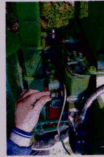
Die Einspritzpumpe mit Kaltstartschalter und Vorpumphebel liegt vor dem Motor.
